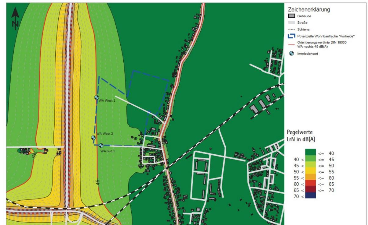
Abbildung 5-2 Rasterlärkarte in 2 m Höhe über Gelände, Beurteilung gemäß DIN 18005, 22:00 - 06:00 Uhr
