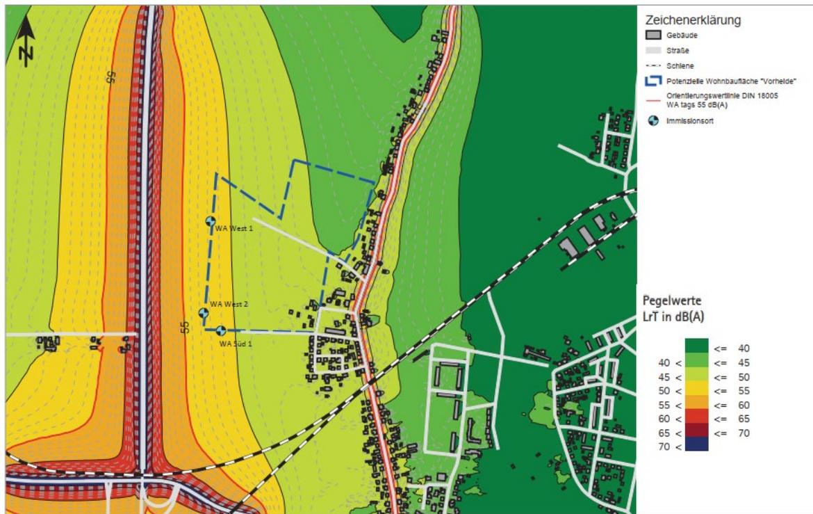
Abbildung 5-1 Rasterlärkarte in 2 m Höhe über Gelände, Beurteilung gemäß DIN 18005, 06:00 - 22:00 Uhr
