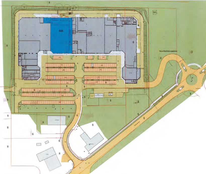
Bild – Alternative der Erschließung vom Kreisverkehr aus bei Beibehaltung der Gebäudestruktur im SO 2 (Fabrik No 40 Weiss&Faust, Berlin, 07.06.2018)
